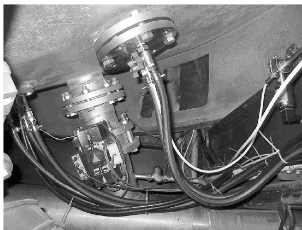
Przykład zabudowy przetwornika różnicy ciśnień typu APR-2000PD z separatorem typu S-TK-P produkcji Aplisens na zbiorniku z cukrzycą w Cukrowni Lublin
