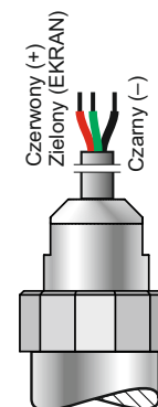
Przyłącze elektryczne kablowe Typ PK Stopień ochrony IP67 Długość kabla 3 m (inna długość kabla - na zamówienie)
