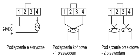
Rys.2 Schemat połączeń elektrycznych
