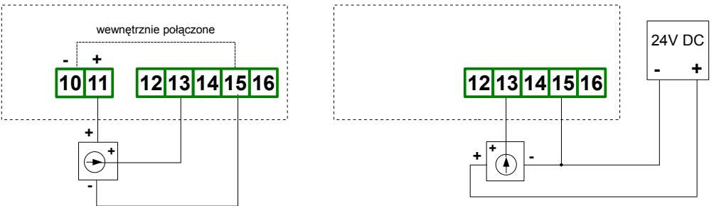
Rys. 4.8. Podłączenia przetworników napięciowych
