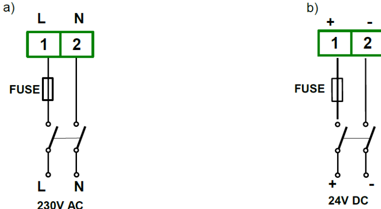
Rys. 4.9. Podłączenie zasilania a) dla wersji 230V AC; b) dla wersji 24V DC
