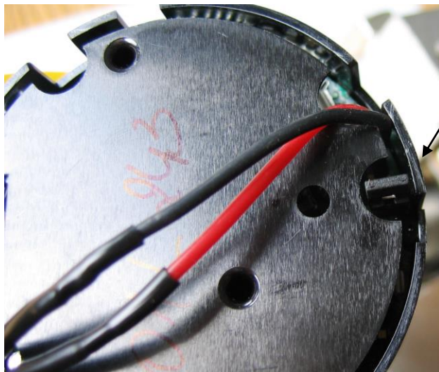
Rys.6. Widok zwory układu podświetlenia wyświetlacza w zespole elektroniki (tylna strona modułu elektroniki).
