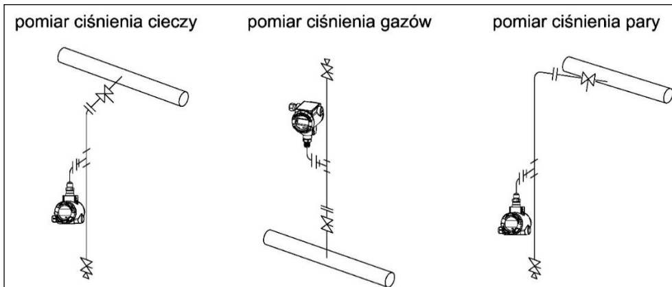
Rysunek 2. Przykłady montażu przetworników ciśnienia
