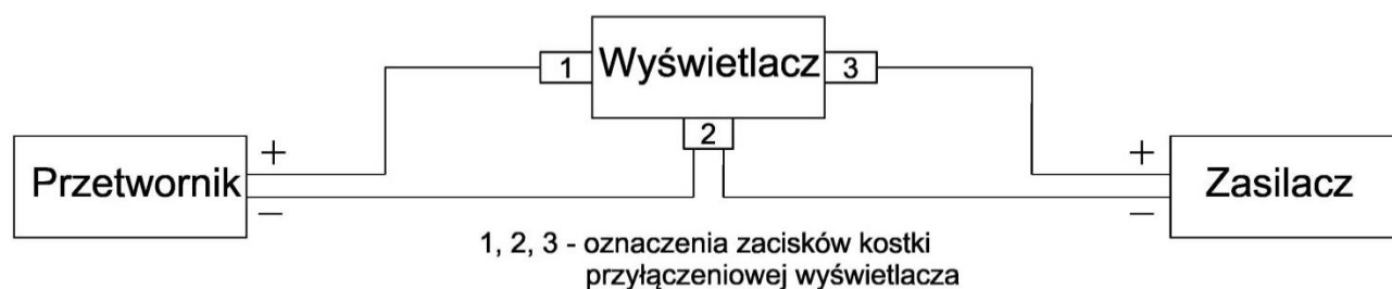
Rysunek 4. Schemat podłączenia wyświetlacza WW-11ALW bez komunikacji Hart.
