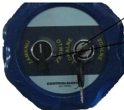
Stacyjka siłownika – funkcje przełączników
